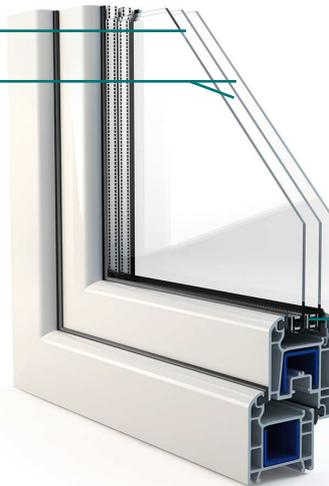
Der **Randverbund** besteht aus Abstandhalter, Dichtungsmaterial, Glas und Rahmen. Er versiegelt die Mehrscheibenkonstruktion hermetisch gegen das Entweichen von Füllgas.
