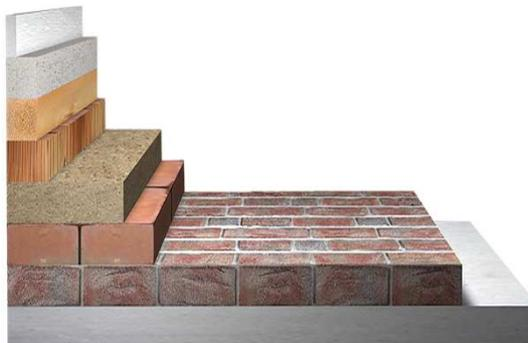
Eine Dämmschicht aus modernen Materialien ist auch durch noch so dicke Wände nicht zu ersetzen: 2 cm üblicher Dämmstoff haben die gleiche Dämmwirkung wie eine 30 cm dicke Wand aus Hochlochziegeln oder eine über einen Meter dicke Betonwand. Wichtiger für den Wärmeschutz ist nicht die Dicke des Baustoffes, sondern dessen Wärmeleitfähigkeit.
